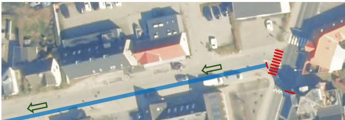
Figur 6 Grov principskitse af signalreguleret cykeltrafik fra Byvej og fodgængerfelt som del af eksisterende signalreguleret fodgængerfelt på tværs af Rosenholmvej
